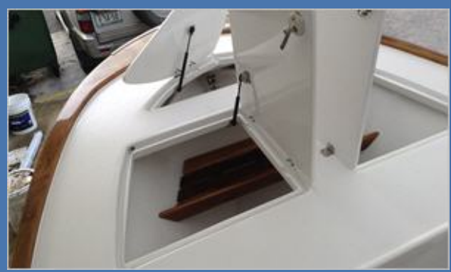
Actual Boat Showing Hatch Lids & Gutter Framing
